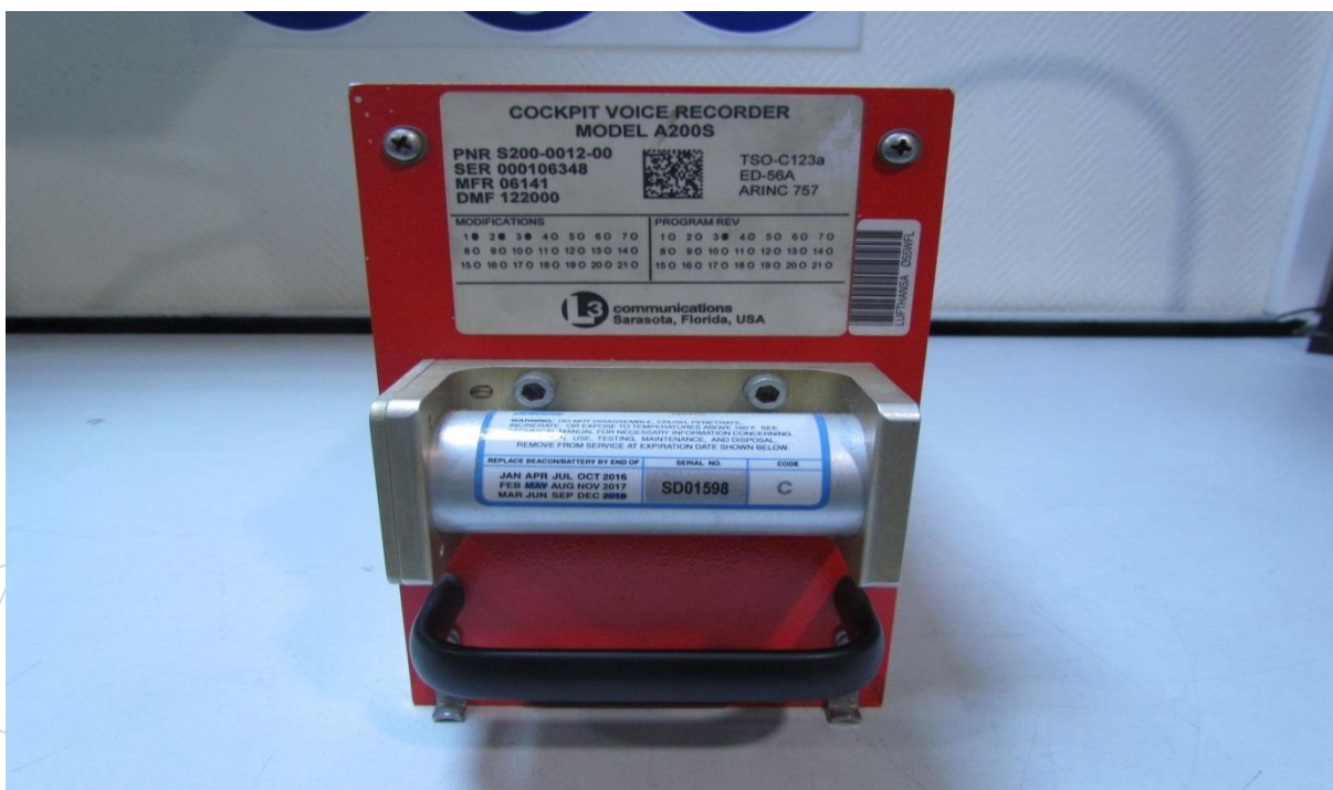
Fig.8 Echipamentul CVR ridicat de la bordul aeronavei și trimis spre decodificare la BEA
